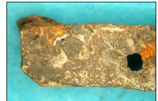
Très forte oxydation et dézincification de contacts électriques en laiton (Cuivre+Zinc) prélevés dans une cabine d'engin forestier examiné sur site en forêt 14 mois après son incendie. Ces contacts susceptibles d'être à l'origine de l'incendie de cet engin sont devenus inexploitable (Microscopie optique classique X15).
