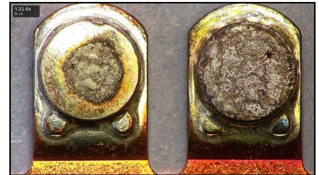
Traces d'amorçages électriques sur pastilles de contact de batterie de condensateurs (microscope optique 3D x22).
