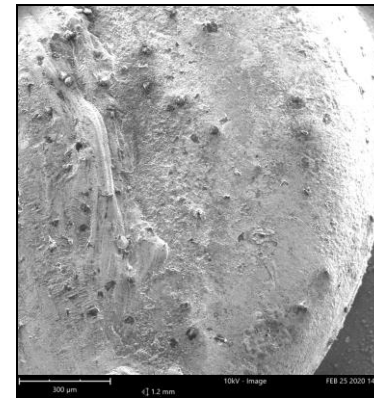
Etat de surface d'une pastille de contact de relais électrique de véhicule ayant subi un mauvais contact et un départ de feu (x200).
