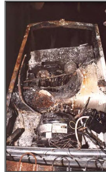
Surchauffe de la cloche d'un réfrigérateur
