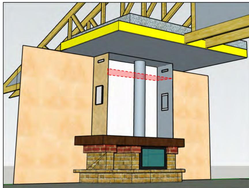
En 2006, les DTU 24.1 et 24.2 n'utilisent plus la notion d'écart au feu mais introduisent celle de « *distance de sécurité* » qui est plus facile à mesurer et qui correspond à la distance entre la face externe du conduit et les matériaux combustibles avoisinants. Cette distance de sécurité dépend des paramètres suivants :
